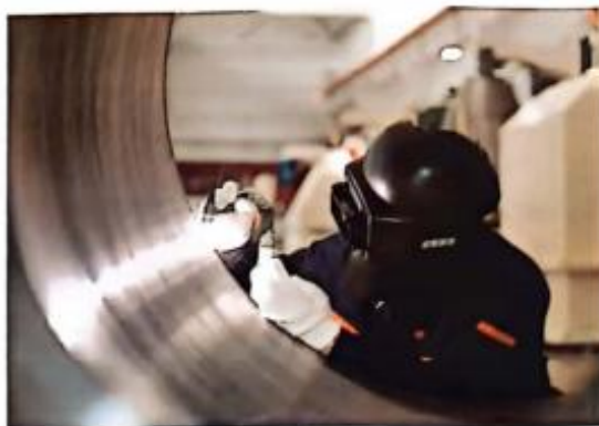
图8-8 我国工匠正在焊接火箭发动机喷管
