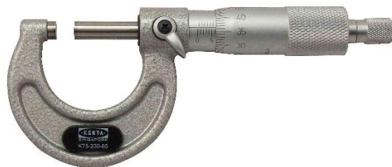
图 4-3 螺旋测微器
